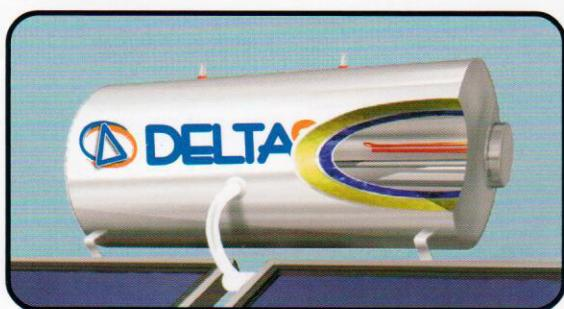
ανοξείδωτο ατσάλι AISI 316L πάχους 2mm και θερμοδοχείο Glass από χάλυβα χαμηλής περιεκτικότητας σε άνθρακα, με διπλή επισμάτωση σε θερμοκρασία ψησίματος στους 860°C σύμφωνα με τα πρότυπα DIN 4753/T3. **Ανόδιο μαγνησίου** προστασίας του δοχείου από το φαινόμενο της ηλεκτρόλυσης και **μόνωση δοχείου** από οικολογική πολυουρεθάνη πάχους 50 mm και πυκνότητας 40kg/m<sup>3</sup>.
